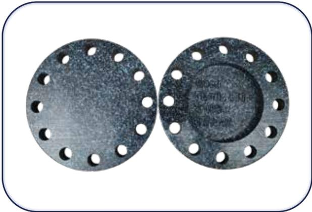
Die Radnabendeckel dienen zum Verschließen der Radnaben nach dem Ausbau der Steckachsen. Die Deckel verhindern das Austreten von Öl, das Eindringen von Schmutz und Wasser in die Radnabe und die Radlager. Die Verwendung erfolgt mit Original Schrauben ohne zusätzliche Unterlegscheiben.
